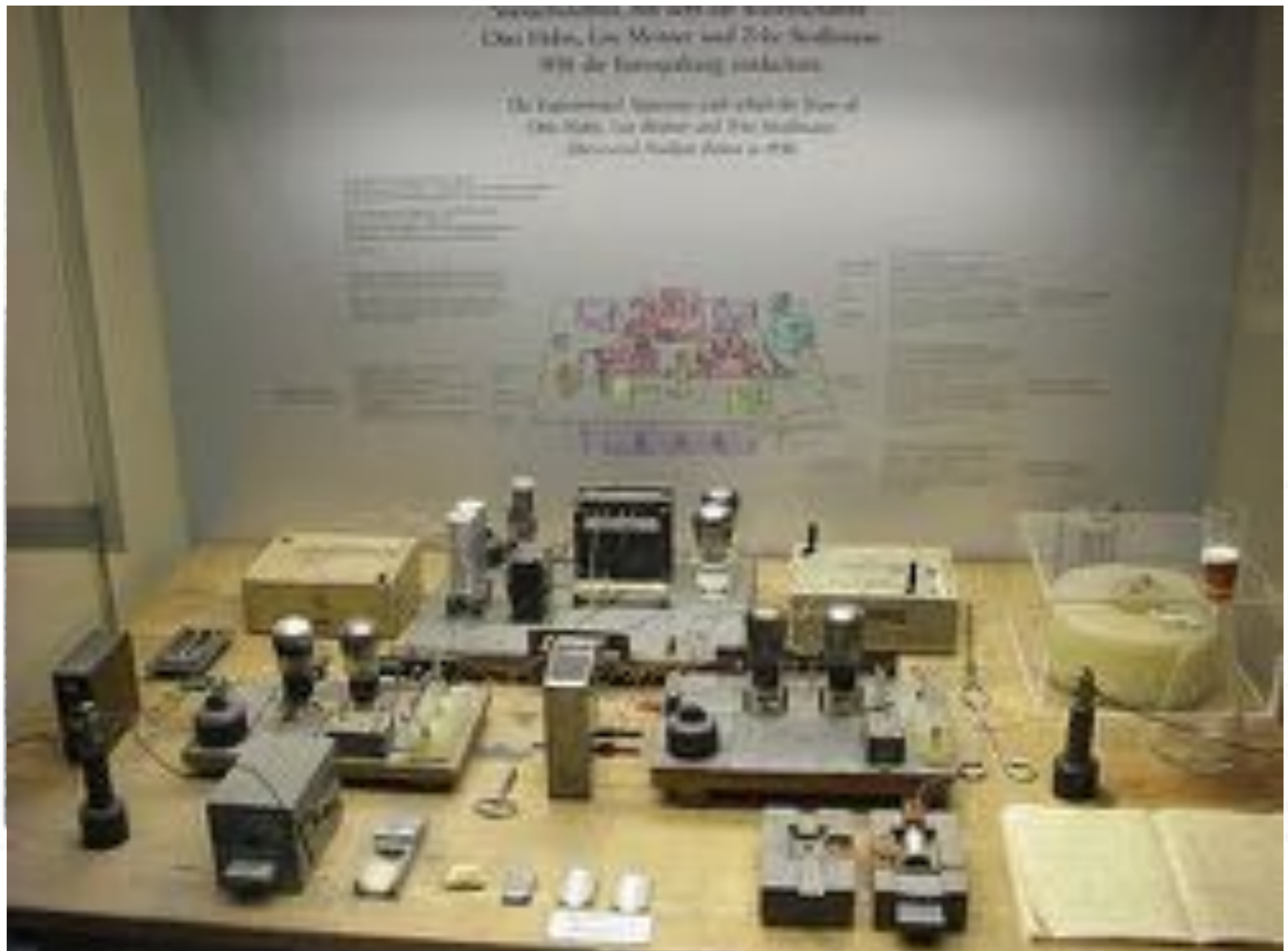
ベルリンのカイザーウィルヘルム研究所で、マイトナーがハーン、シュトラスマンと共に行った実験の装置・器具。ウランの核分裂はこのような簡素な装置で 1938年12月 に発見された。
